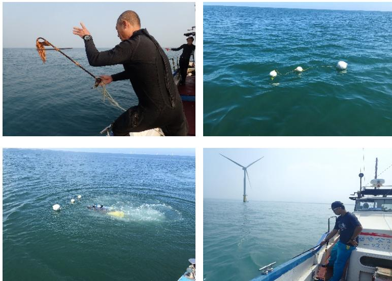
圖2.2-1 儀器替換及回收海上作業流程（左上：將定點錨拋入海中、右上：拋出連接定點錨之主纜繩、左下：潛水夫沿著主纜繩下潛、右下：船上工作人員注意潛水夫之暗號與氣泡位置）
