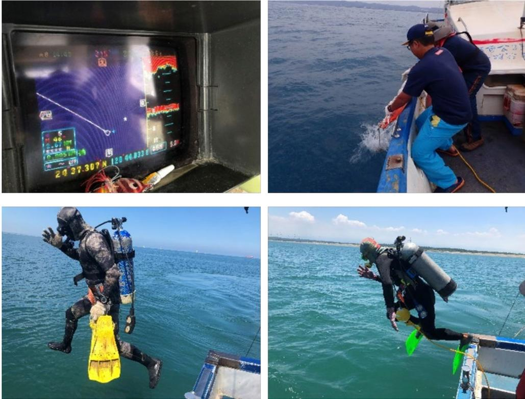
圖 2.1-2 底碇式佈放流程示意圖 (左上：魚探機、右上：垂直拋入重物、左下：1 號潛水夫下潛、右下：2 號潛水夫下潛)
