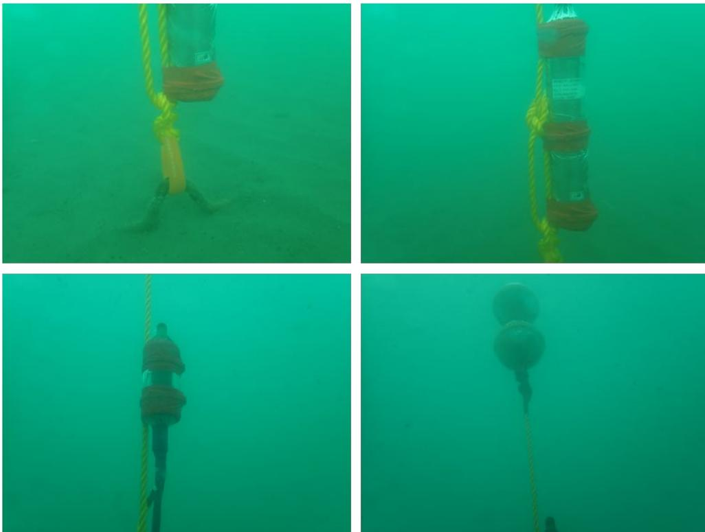
圖 2.1-1 底碇式佈放示意圖（左上：鐵板與繩索固定處、右上：電池盒、左下：錄音機、右下：浮球）
