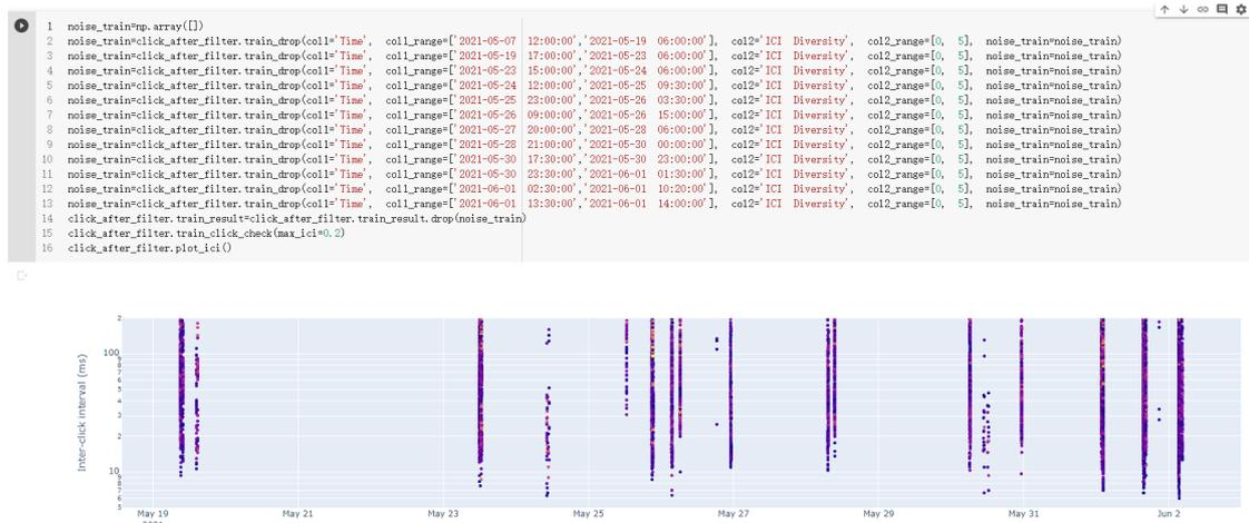
圖 4.1-9 手動刪除偵測錯誤的搭聲時間區段
