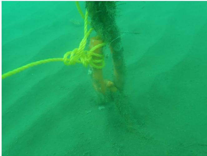
圖 4.2-1 底碇重物被泥沙覆蓋之示意圖
