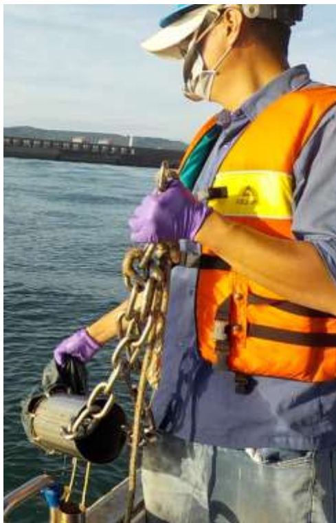
圖 3.3-1 圓筒式採樣器(採樣照)
