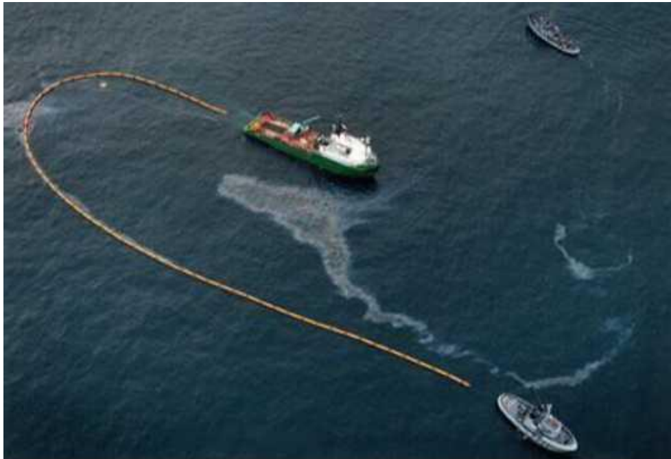
圖 3-10 利用船舶拉攔油索進行溢出物圍堵（J 型）
