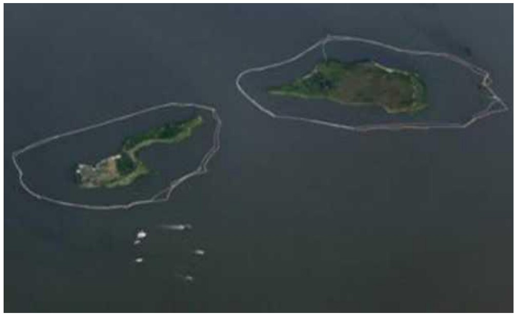
圖 3-9 利用攔油索保護海岸線 Deepwater Horizon（2010）
