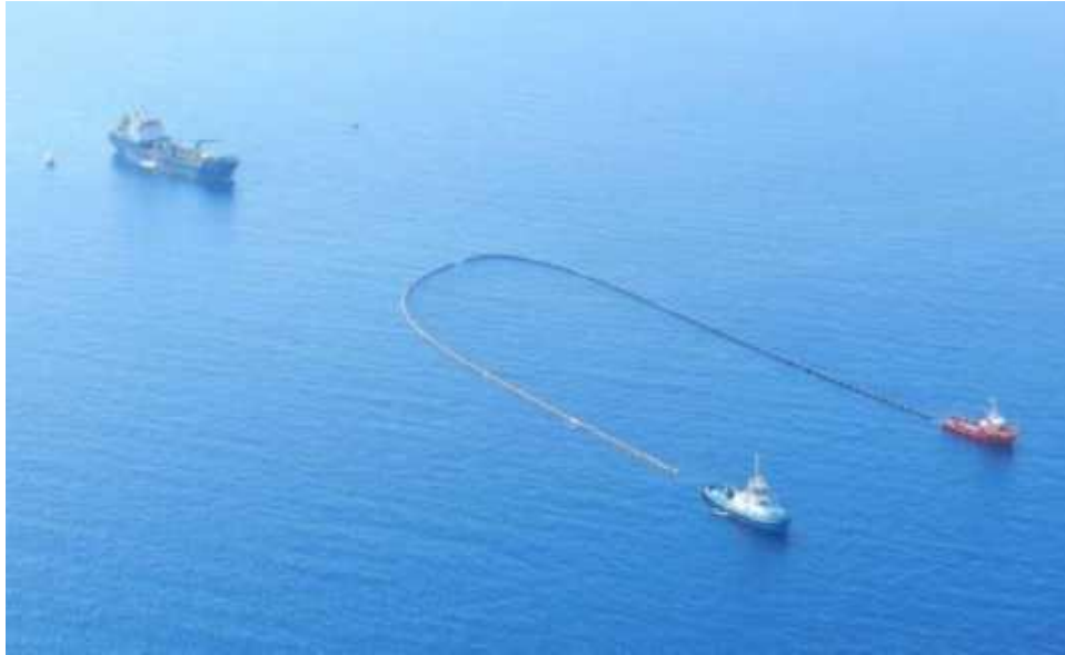
圖 3-11 利用船舶拉攔油索進行溢出物圍堵（U 型）
