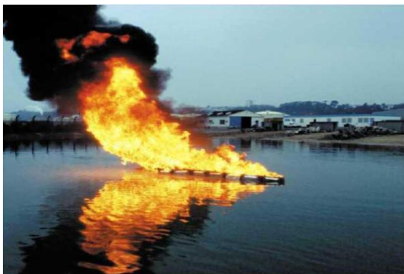
圖 3-12 用於控制著火的浮油及進行就地溢出物之燃燒作業
