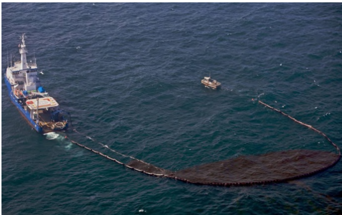
圖 3.3.3-2 使用自走式汲油器之雙船作業
