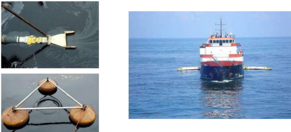
圖 3-8 機械式回收油品作業
