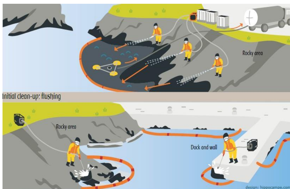
圖 3-7 攔油索圍堵作業功效
