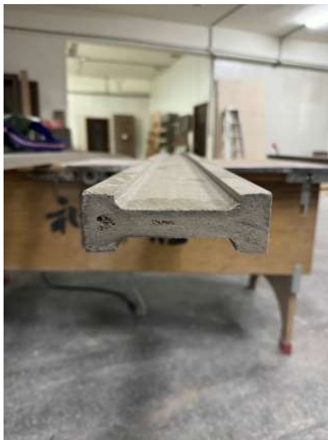
圖 3-23、S-TjGW4*12(I 型異形材)產品圖示
