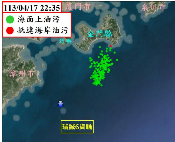
圖 3-1-93 SCHISM 模擬未來 12 小時油污染擴散模擬結果
