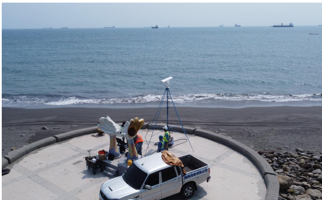
圖 3-4-1 X-band 雷達油污偵測系統執行作業情形
