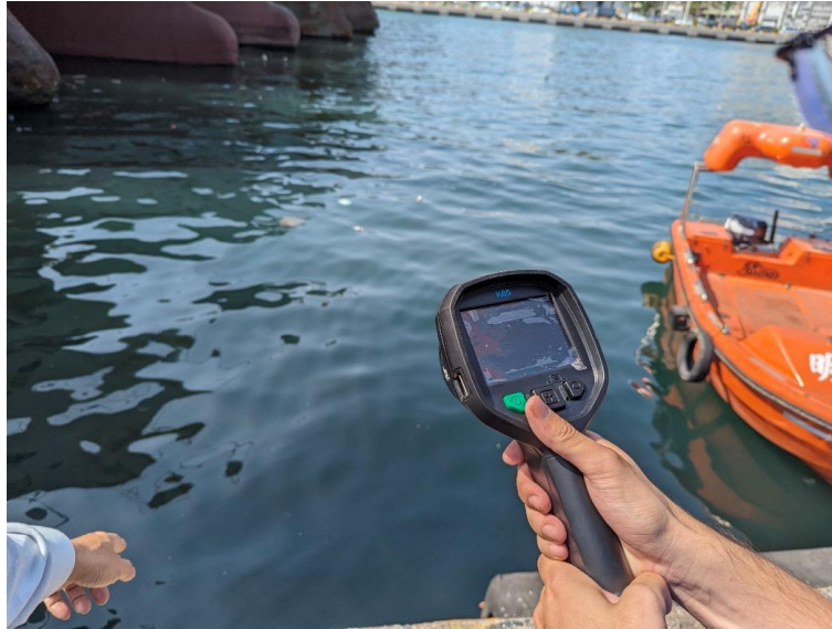
圖 3-4-16 測試 FLIR K65 偵測油污的能力
