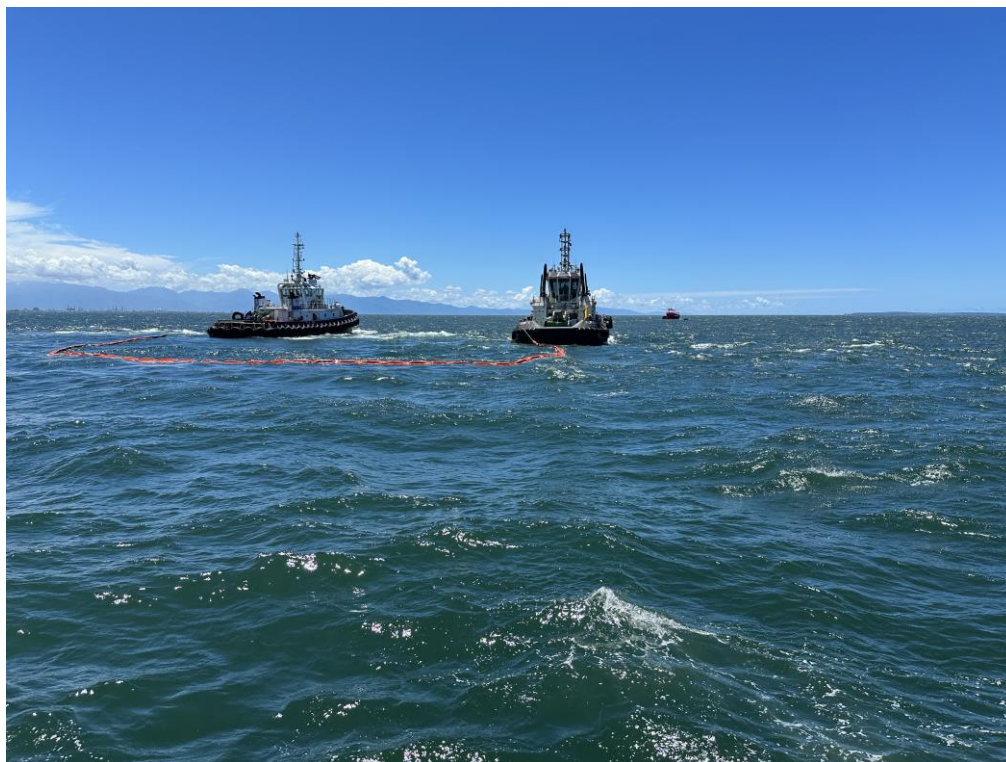
圖 3-1-86 中油公司工作船在海上佈設第一道攔油索防止油污擴散
