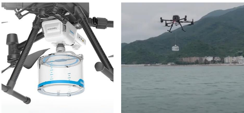
圖 3-4-33 Soarability Speedip V2 採水器與其作業情形。
