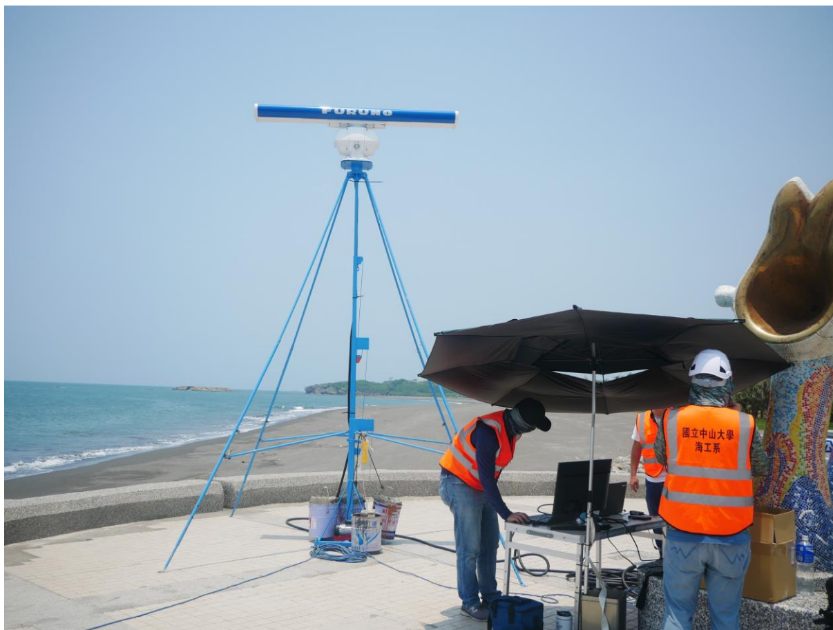
圖 2-4-3 X-band 雷達在旗津海岸進行兵棋推演之油污染監測作業
