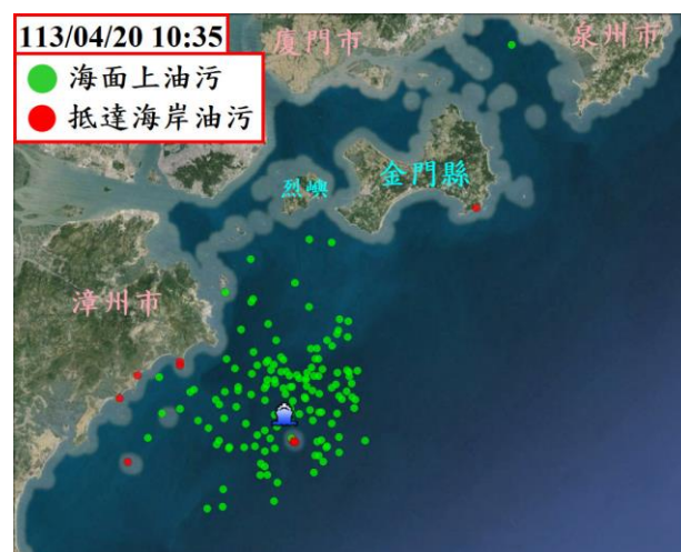
圖 3-1-13 GNOME 模擬未來 72 小時油污染擴散模擬結果
