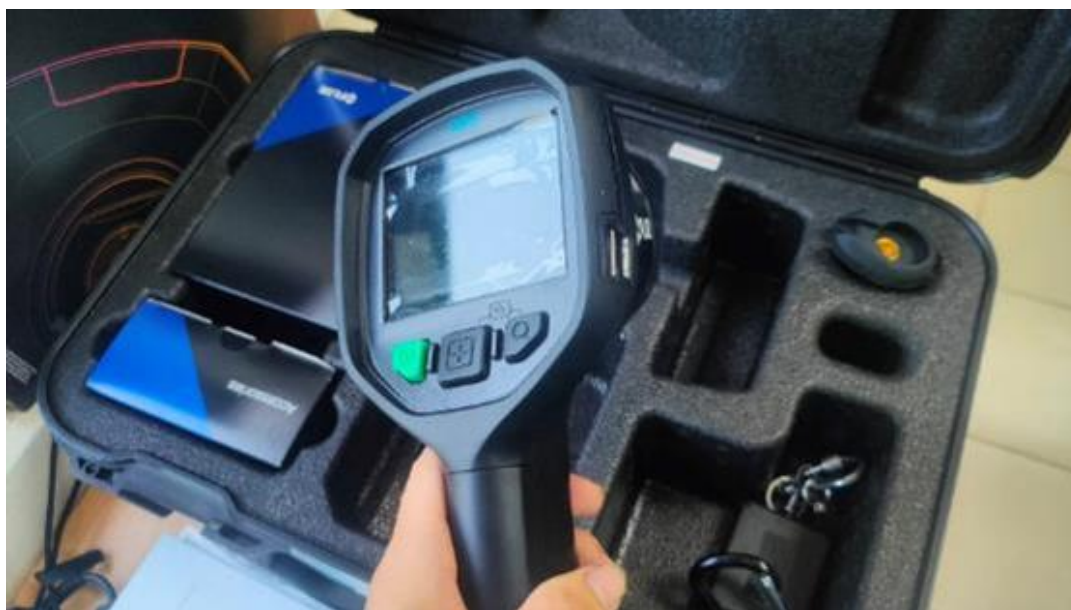
圖 3-4-15 FLIR K65 救災用紅外線熱影像儀
