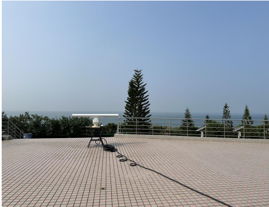
圖 2-4-1 X-band 雷達偵測油污作業系統
