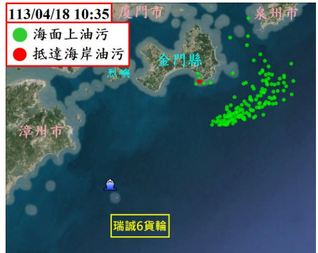
圖 3-1-94 SCHISM 模擬未來 24 小時油污染擴散模擬結果
