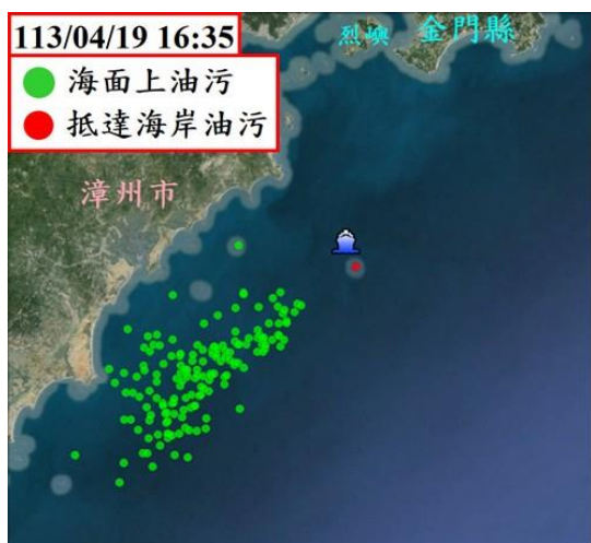
圖 3-1-100 SCHISM 模擬未來 48 小時油污染擴散模擬結果
