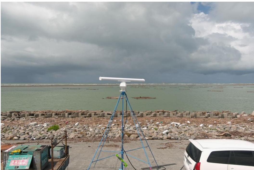
圖 3-4-5 X-band 雷達於 7 月 30 日 18:00 進行油污監測作業
