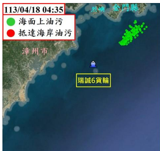
圖 3-1-98 SCHISM 模擬未來 12 小時油污染擴散模擬結果
