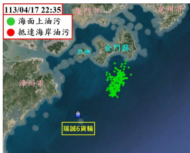
圖 3-1-10 GNOME 模擬未來 12 小時油污染擴散模擬結果
