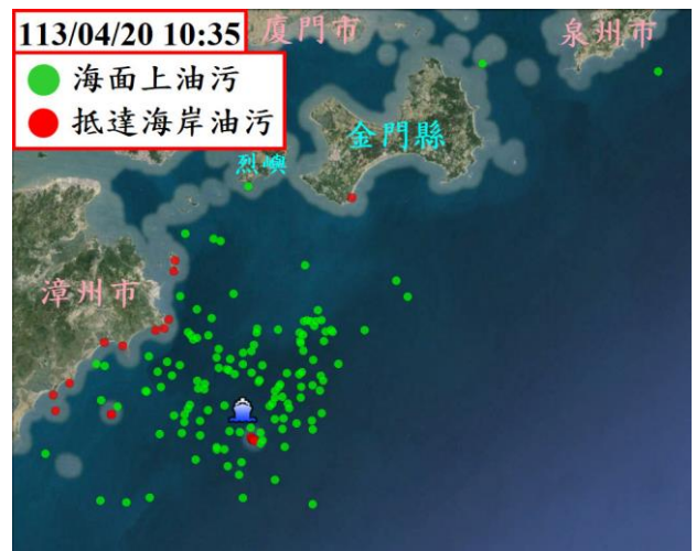
圖 3-1-96 SCHISM 模擬未來 72 小時油污染擴散模擬結果
