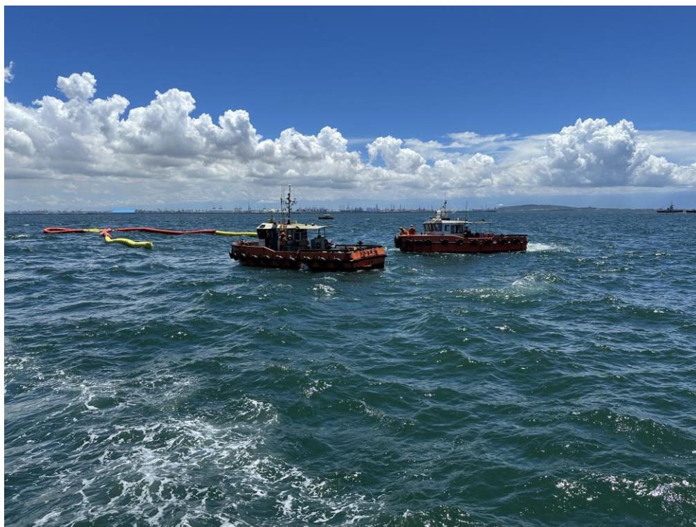
圖 3-1-87 中油公司工作船在海上佈設第二道 U 型攔油索圍堵集中海面油污
