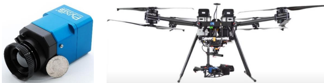
圖 3-4-21 美國 Polaris Sensor Technologies 公司開發之 Pyxis LWIR 油污偵測影像模組與整合至無人飛行載具之應用範例。
