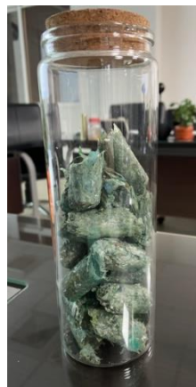
圖 86 廢浮球再利用製成 SRF 燃料棒 119
