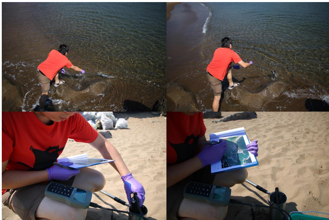
人員利用採水器採集樣本並使用手持式水質探測儀檢測水質數據
