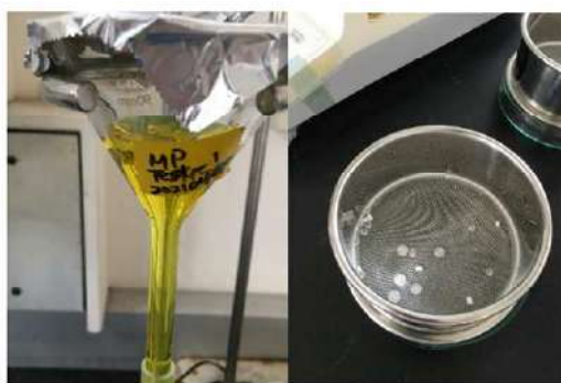
圖 3.2-17 密度分離靜置和萃取過程
