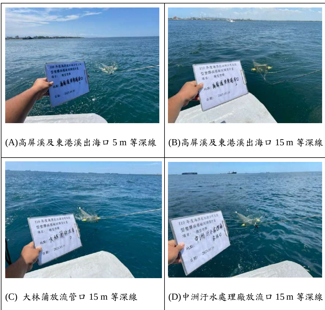
圖 3.2-2 高屏溪及東港溪出海口、大林蒲放流管口及中洲汙水處理廠放流口海域採樣作業
