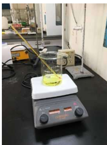
圖 3.2-15 加入 Fenton 試劑在 75^{\circ}\text{C} 下反應
