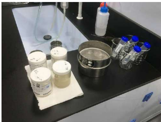
圖 3.1-12 將樣品轉移至離心管中
