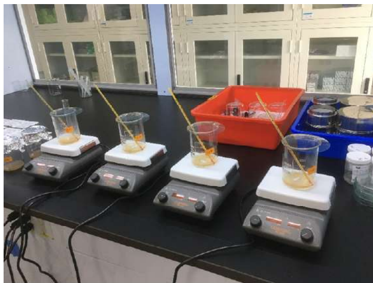
圖 3.1-9 濕式氧化法消化過程
