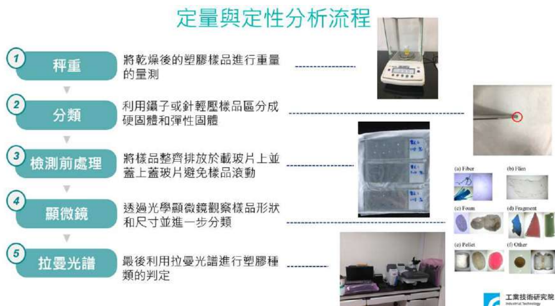
圖 3.2-28 海水樣品定量與定性分析流程
