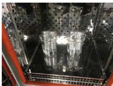
圖 3.2-19 將樣品放入的烘箱中烘乾
