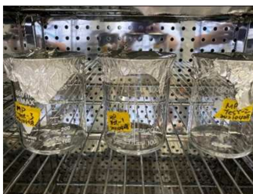
圖 3.2-14 將樣品放入 90°C 的烘箱中
