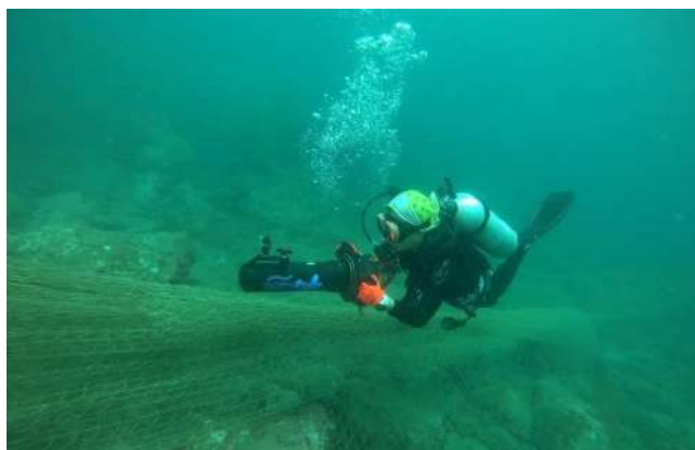
▲ 利用推進器提高，潛水員於水下移動速度，以提升海底巡查效率
