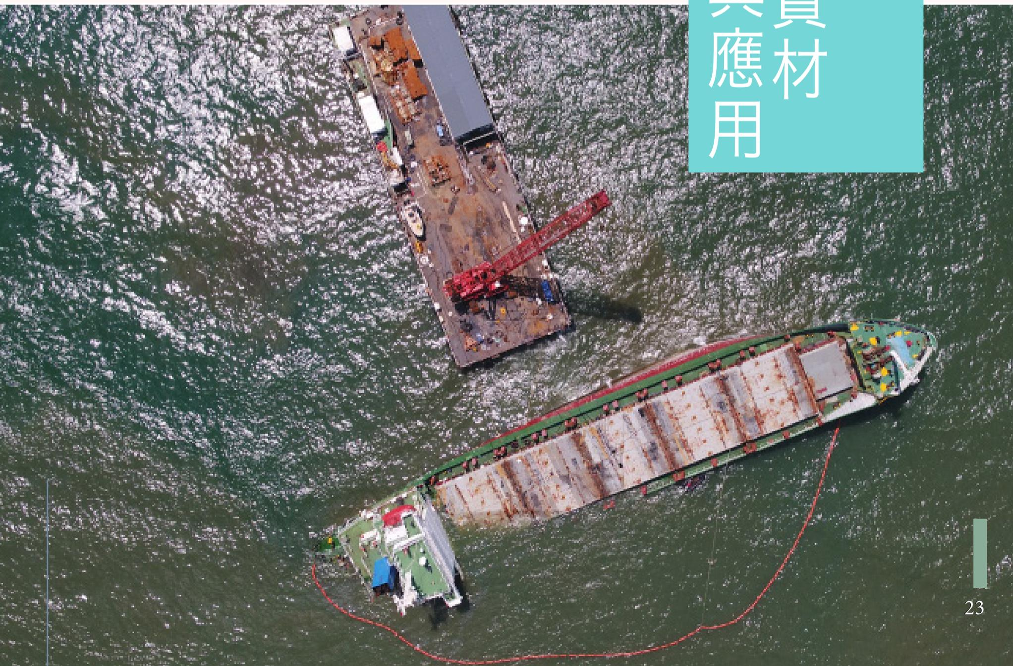
首先，通知管線所有人立刻關閉油管，應變人員馬上前往現場勘查污染狀況與範圍後，決定調用大型抽吸油車趕快把大量油污吸除，再搭配佈設攔油索圍堵油污，同時使用吸油棉清除溢油，後續再開挖路面修復破損油管，減緩溢油對環境的影響。緊急應變必須講求快、狠、準！哇～可是攔油索、吸油棉型式、種類這麼多，我們應該怎麼選擇呢？
